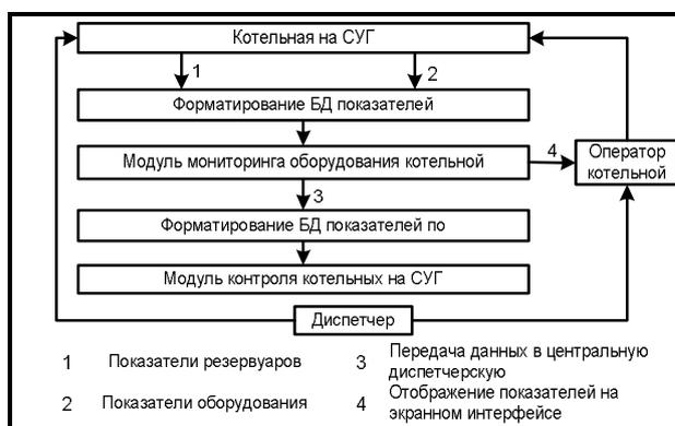
Рис. 4. Последовательность передачи информации при использовании автоматизированной системы
