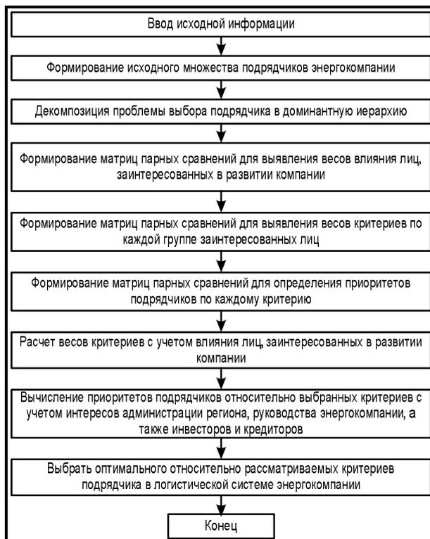
Рис. 3.1. Блок-схема алгоритма выбора подрядчика в логистической системе энергокомпании
