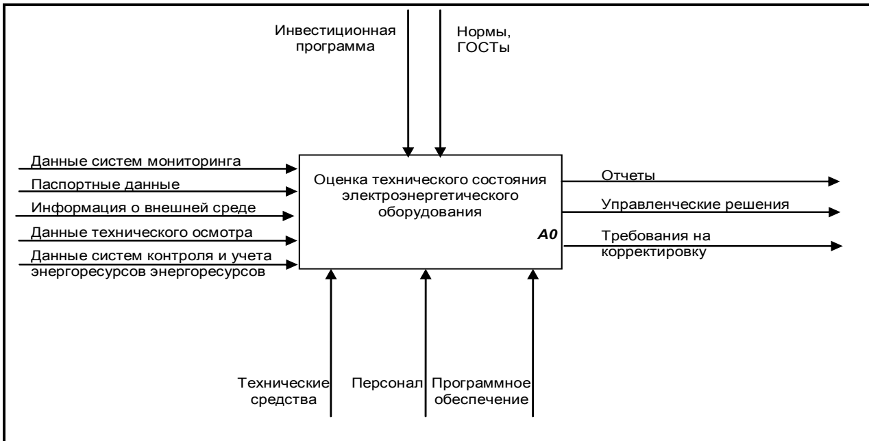
Рис. 1. Контекстная диаграмма описания процесса оценки состояния оборудования электроэнергетического объекта
