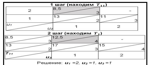
Рис. 7. Решение системы уравнений 1 методом сетевого программирования
