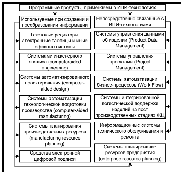
Рис. 6. Классификация программных продуктов по степени принадлежности к ИПИ-технологиям
